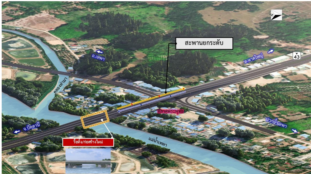
รูปที่ 6-3 รูปแบบที่ 1 สะพานยกระดับตามแนวทางหลวงหมายเลข 43 (Fly Over) ร่วมกับวงเวียน (Roundabout)
