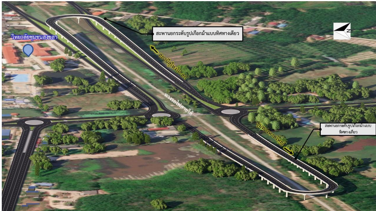
รูปที่ 6-6 รูปแบบที่ 2 สะพานยกระดับรูปเกือกม้าแบบทิศทางเดียว (1-Way U- Turn) ร่วมกับวงเวียน (Roundabout)
