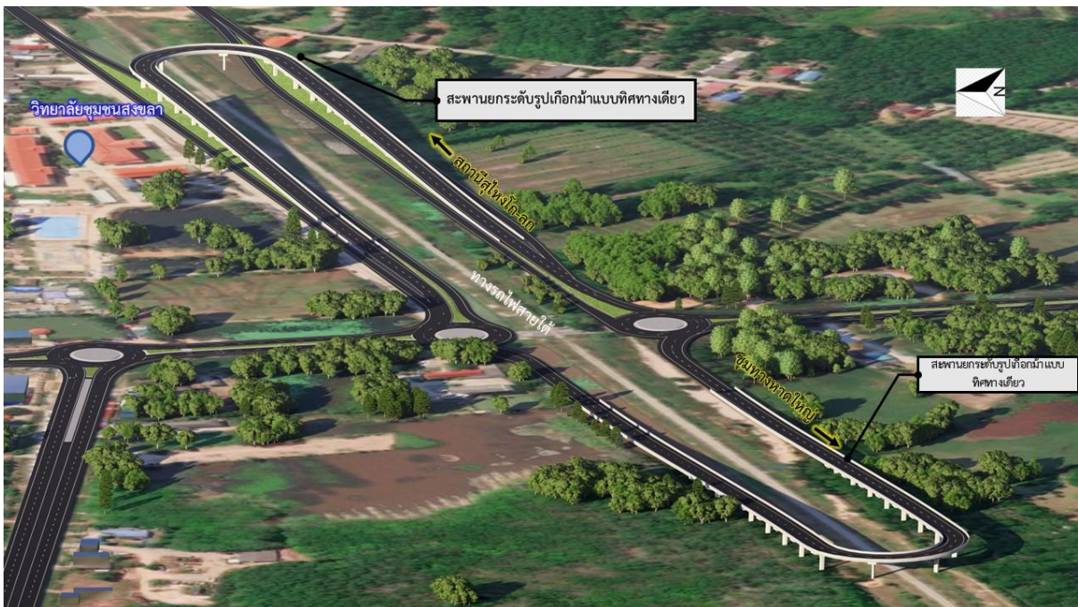
รูปที่ 7-3 รูปแบบที่ 2 สะพานยกระดับรูปเกือกม้าแบบทิศทางเดียว (1-Way U-Turn) ร่วมกับวงเวียน (Roundabout)
